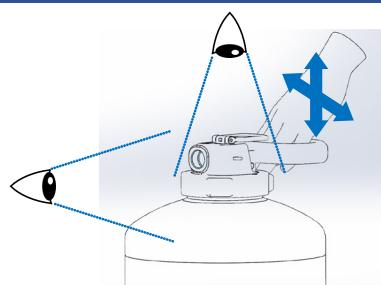
Exemple d'un vissage correct ✓
