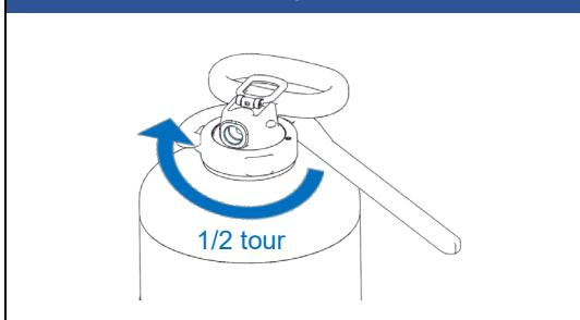
**6** Vérifier le bon serrage de la tête en effectuant avec la poignée des mouvements verticaux et horizontaux. Vérifier visuellement de profil et par le dessus le bon positionnement de la bague sur le filetage du cylindre
