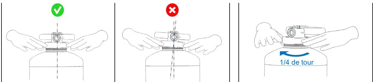
**3** Confirmer le bon engagement de la bague sur le filetage du cylindre en effectuant un mouvement vertical de haut en bas
