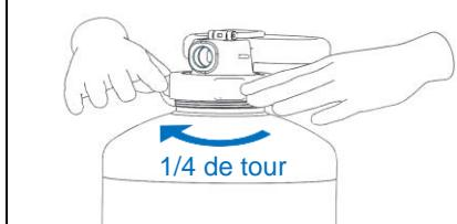
**3** Confirmer le bon engagement de la bague sur le filetage du cylindre en effectuant un mouvement vertical de haut en bas
