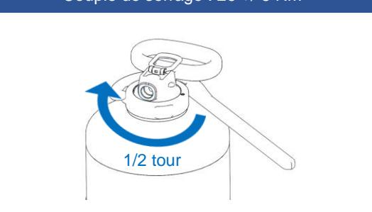
**6** Vérifier le bon serrage de la tête en effectuant avec la poignée des mouvements verticaux et horizontaux.
