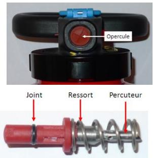
Oter le kit percuteur (H) à l'aide d'une pince à bec (2 pièces et 1 joint) et vérifier son état.
