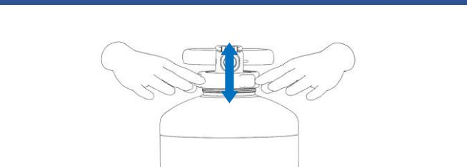
**4** Serrer manuellement d'au minimum 3/4 de tour et jusqu'à résistance
